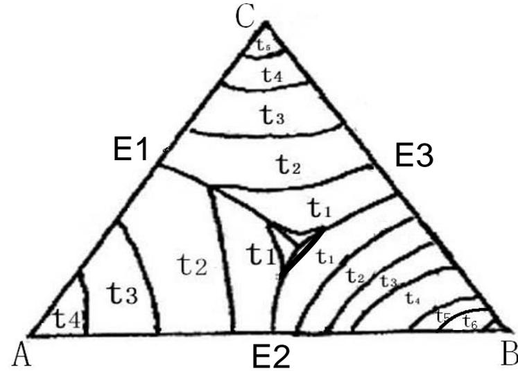
3. 已知A, B, C三个组元, 熔点分别为 $t_A = 1050^\circ\text{C}$ ,  $t_B = 980^\circ\text{C}$ ,  $t_C = 1300^\circ\text{C}$ , 形成简单三元低共熔点相图, 其三元低共熔点 $t_E = 800^\circ\text{C}$  (35% A, 40% B, 25% C)。A-B, B-C, C-A均形成简单二元低共熔相图, 其二元低共熔点分别为 $t_{E1} = 850^\circ\text{C}$  (40% A, 60% B),  $t_{E2} = 910^\circ\text{C}$  (35%B, 65%C),  $t_{E3} = 1000^\circ\text{C}$  (70%A, 30%C) (均为重量百分数)。
