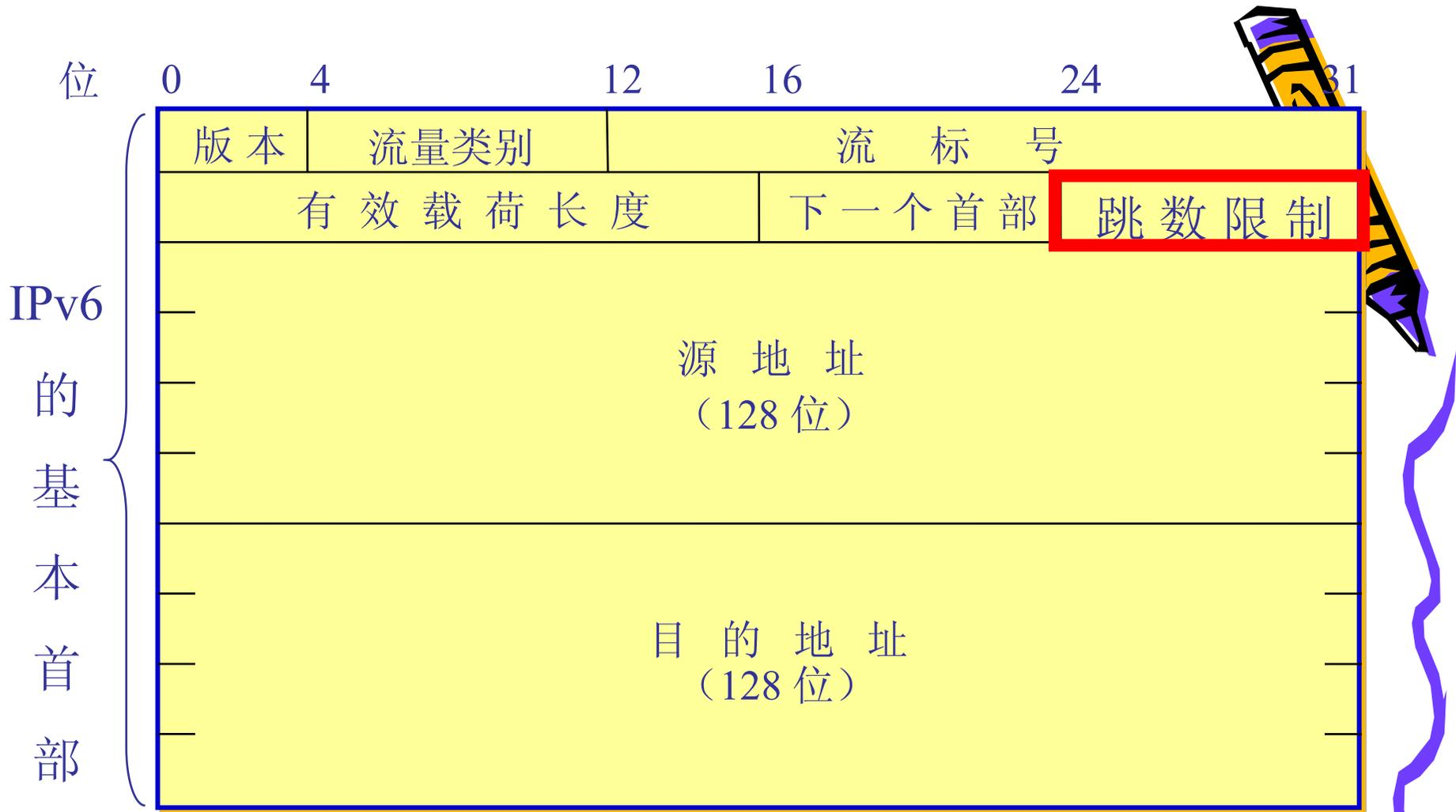
跳数限制(hop limit)—— 8 位。源站在数据报发出时即设定跳数限制。路由器在转发数据报时将跳数限制字段中的值减1。
