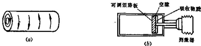
图6.3-9 TE 011 模式电流分布与调谐方法
