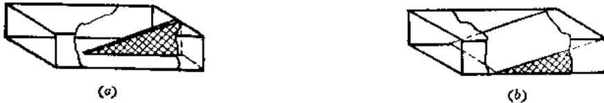
图8.1-4 低功率波导匹配负载 (a) 劈形吸收片；(b) 有耗楔形吸收体。
