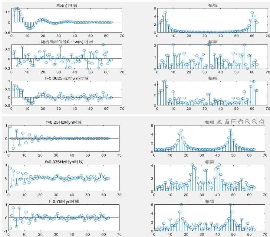
固定衰减因子不变，频率较小时，可以看到频域波峰位于两端，说明低频成分占比多。加入噪声信号后，频谱高频成分有所增加。F 越大，频谱波峰位置越靠近中央，混叠更易发生，同时带有泄漏。F 越大，现象越明显。
