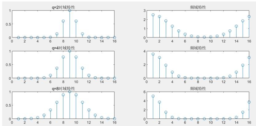
比较上图可知,  $p$ 一定时,  $q$ 增大, 高斯信号在时域波形展宽且变得平缓; 而频域波形变陡, 频谱分量减少。所以  $q$ 决定了高斯信号的陡峭程度。
