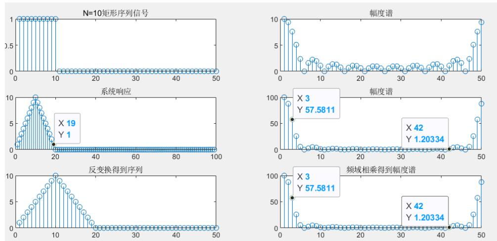
因为  $X_c(n)=H_a(n)$ , 所以两者的时域和幅频特性应该相同。时域有 10 个非零值点, 幅频两极大值之间有  $10-2=8$  个次峰。线性卷积之后得到的序列时域和幅频特性如上图, 因为矩形序列非零长度为 10, 所以卷积结果非零长度应该为  $10+10-1=19$ , 可以看到实验结果与理论结果一致。并且卷积得到的序列应该是一个三角波, 峰值为 10, 正如图中结果所示, 所以响应序列图形是正确的。计算两个矩形序列傅里叶变换的乘积得到响应序列幅频特性, 与线性卷积得到的序列幅频特性相同, 并且反变换之后得到的响应序列也相同。
