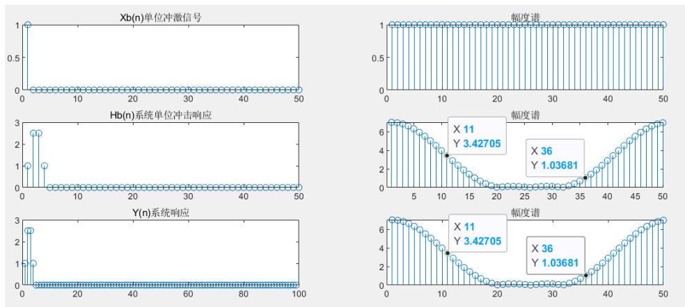
$X_b(n)$  是单位脉冲序列，幅频特性在全频域上都为 1，如上图，和理论相符。 $H_b(n)$  是系统单位冲击响应，与单位脉冲卷积之后，按照卷积相关性质，结果得到的信号与  $H_b(n)$  相同，如上图可见，系统响应在时域和频域特性都和  $H_b(n)$  相同。由于线性卷积的原因，系统响应有  $50+50-1=99$  个点，所以  $Y(n)$  时域如上图。
