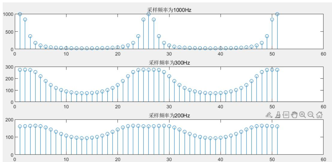
采样频率减小到 200Hz 时已经出现了明显频谱“混淆”现象。因为采样频率太小，频谱在频域的周期延拓较小，会导致频谱混叠，从而“混淆”。
