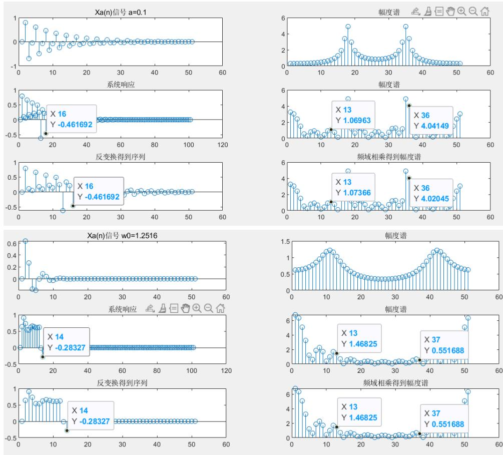
改变 $\alpha=0.1$ 时，衰减因子减小，信号  $X_a(n)$ 衰减速度相比原来有所减缓，幅频特性比原来的幅频特性各分量都要小，但峰值位置相同。此时线性卷积结果与傅里叶变换乘积得到的幅频特性有微小差异，这是因为衰减速度减缓，仍对于之前的 50 点截取，会在一定程度上产生频谱泄露，所以两个结果有微小不同。预计若采取更多点数截取，如 100 个点，上面二者结果在一定误差下会保持相同。
