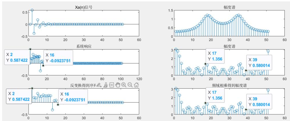
$X_a(n)$  信号与系统单位冲击序列线性卷积得到的结果, 与二者傅里叶变换乘积得到的结果幅频特性相同, 其中, 傅里叶乘积得到的结果反变换与线性卷积得到的序列也相同。
