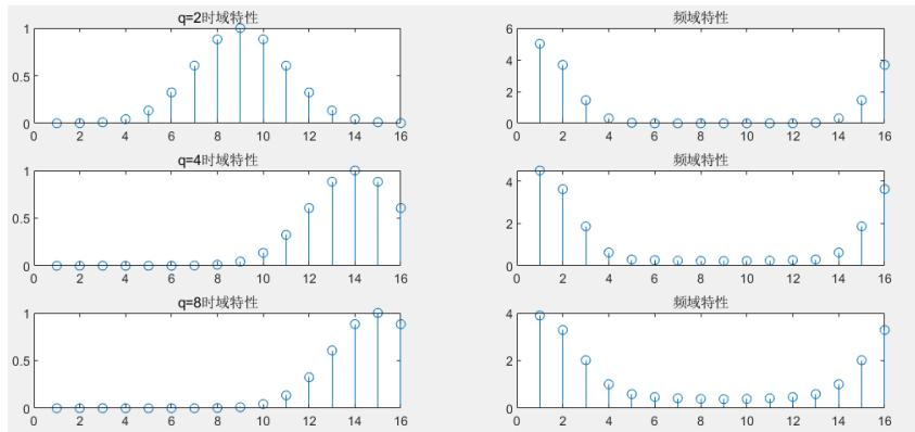
比较上图,  $q$  不变时,  $p$  的值决定了时域波形峰值的位置。当  $p$  增大时, 波形整体向右移动。 $P=13, 14$  时已经发生了明显的泄漏现象。频域部分随  $p$  增大频率分量增加, 容易产生混叠。
