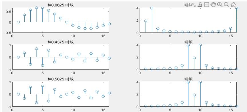
$f=0.0625$  时频谱没有发生混叠,  $f=0.5625$  时频谱发生了混叠。因为  $0.4375+0.5625=1$ , 出现镜像频率, 所以  $f=0.4375$  和  $f=0.5625$  的频谱图像完全相同。
