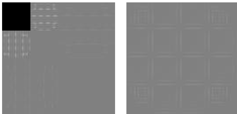
图 10: 教材图 7.27 复现结果 (近似分量置零并反变换)
