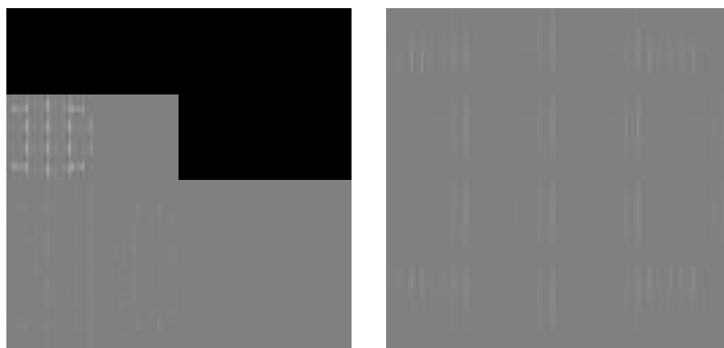
图 11: 教材图 7.27 复现结果 (进一步将水平细节置零并反变换)
