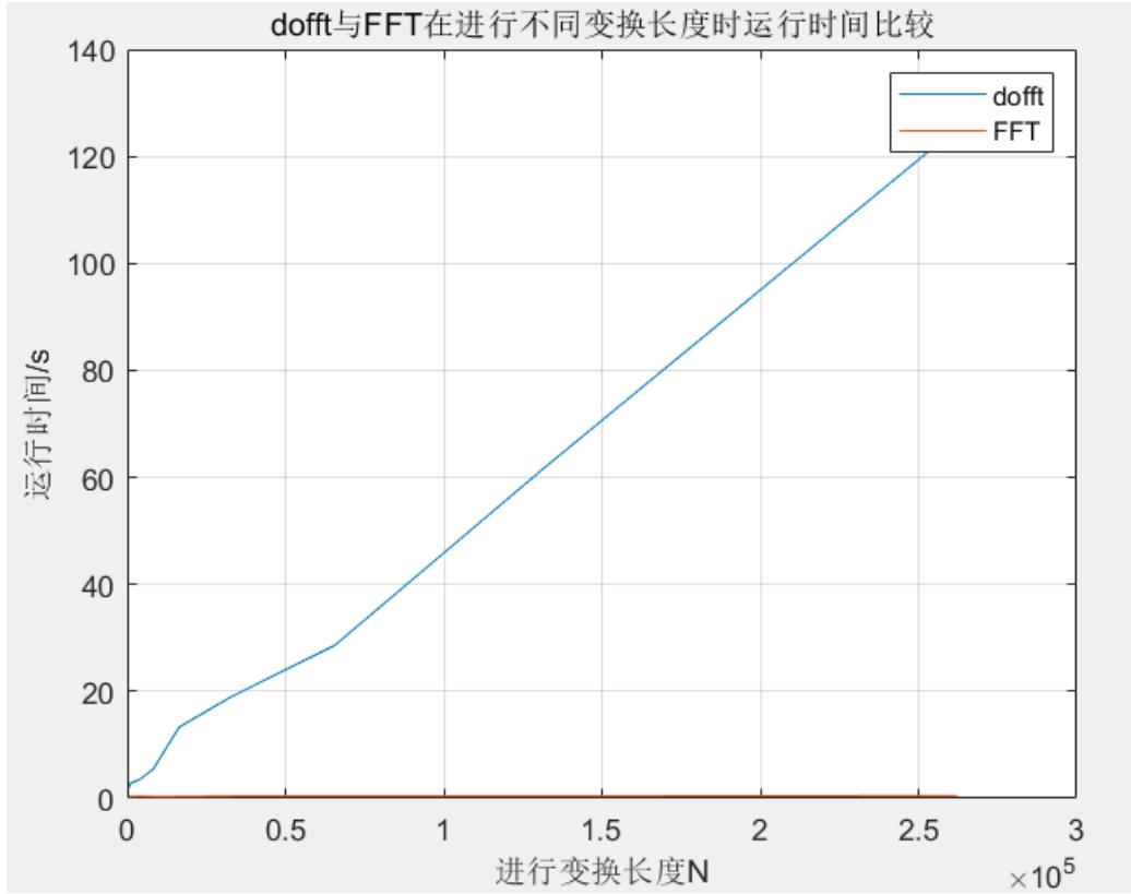
自己编写的 doft 在进行变换长度的横坐标下近似线性增长。而 MATLAB 本身的 FFT 基本上随着 N 的增大，运行时间基本上没有变化。显然 doft 性能比 fft 性能差。想必 MATLAB 中的 fft 函数进行了更多技巧和优化。
