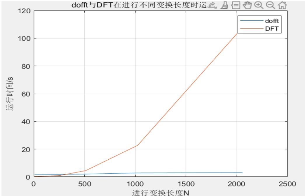
测试序列为理想采样序列。为避免循环运行时，MATLAB 程序在前一循环已在内存中开辟空间和留有数据，测试程序中使用了 clear all 命令来清除内存中的数据。这样测得的时间更加准确。从记录的运行时间中可以看到，当 N 比较小的时候，DFT 运行时间比 dofft 时间更小，这是因为 DFT 算法使用的是向量运算，而 dofft 中使用了循环。MATLAB 本身对于向量计算的速度快于循环的计算速度。所以如果进一步优化 dofft 算法，可以改用向量运算，避免循环。当 N 趋于更大时，DFT 运行时间迅速上升，很快和 dofft 运行时间不在一个数量级。这和 DFT、FFT 两算法的理论时间复杂度一致。
