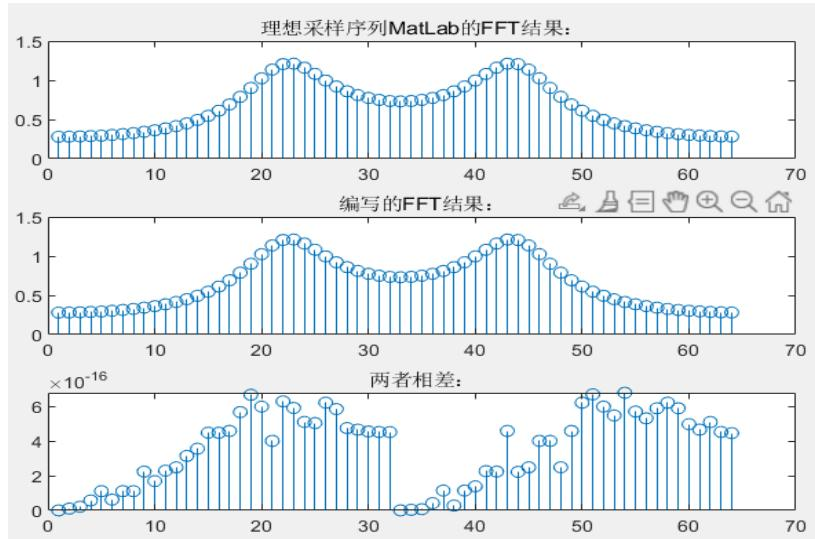
注意每个序列自己编写的 FFT 计算结果和 MATLAB 的 FFT 计算结果，两者相差数量级在  $10^{-16}$  到  $10^{-14}$ 。说明编写的 FFT 算法正确性没有问题。
