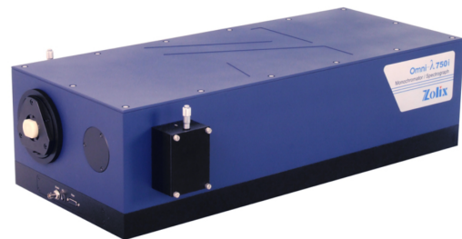
图 5: 光栅光谱仪示意图 (同公司 750i 版本)
