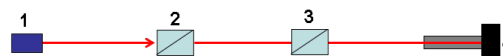
图 4: 实验光路图。1 为半导体红色激光器，2 为偏振片 1，3 为偏振片 2，4 为硅光电探头
