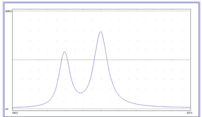
图 8: 红宝石晶体发射谱线
